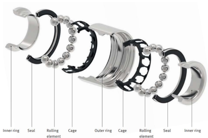
Fig. 5-1: Beispiel Aufbau eines Wälzlagers am Beispiel einer Radlager Kompakteinheit.
