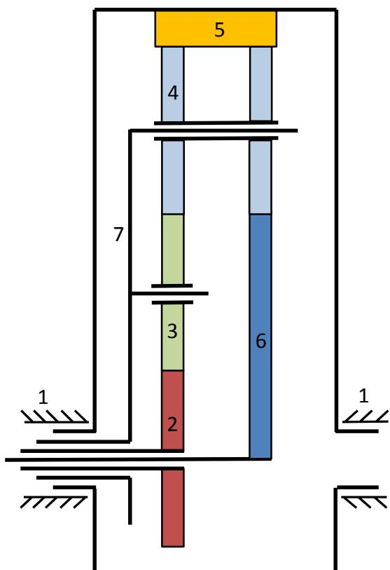
Für den 2. Gang erfolgt der Antrieb am kleinen Sonnenrad (2) mit  $n_{21} = 900 \text{ min}^{-1}$ .
