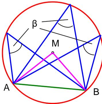
Zieht man die Strecke A – B durch den Mittelpunkt des Kreises, dann ist der Zentriwinkel gleich  $180^\circ$  und jeder Peripheriewinkel gleich  $90^\circ$ . Der Kreis wird zum Thaleskreis:
