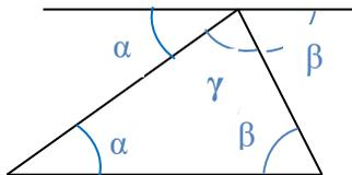
Zieht man durch die Spitze des Dreiecks eine Parallele zur Grundlinie, dann ergeben sich sog. Z – Winkel, d.h. die entsprechenden Winkel im Dreieck und an der Parallelen sind gleich. Die Summe der drei Winkel  $\alpha$
