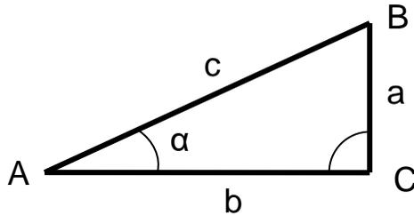
Zwischen dem Winkel  $\alpha$  und den drei Dreiecksseiten  $a$ ,  $b$  und  $c$  lassen sich sechs Verhältnisse bilden, durch die der Winkel  $\alpha$  festgelegt ist. Diese Streckenverhältnisse tragen folgende Namen:
