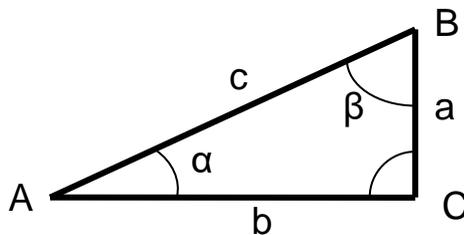
Die beiden Winkel  $\alpha$  und  $\beta$  ergänzen sich zu  $90^\circ$ . Man nennt den Winkel  $\beta$  den Komplementwinkel zu  $\alpha$ . Außerdem ist die Ankathete des Winkels  $\alpha$  gleich der Gegenkathete des Winkels  $\beta$ , sodass gilt:
