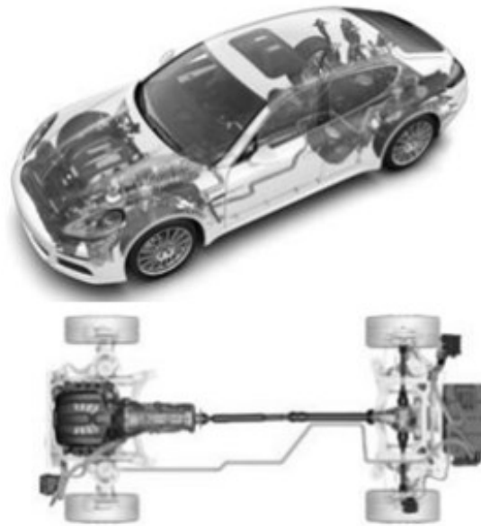
Abb. 3-20: Parallele Struktur des Porsche Panamera S E-Hybrid
