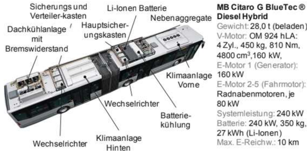
Abb. 3-17: Serielles Hybridfahrzeug - MB Citaro BlueTec® Hybrid
