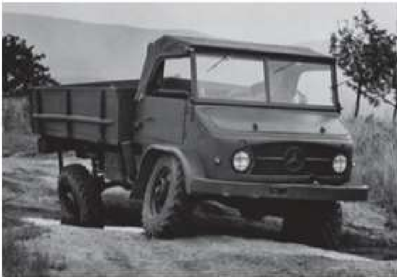
Bild 5.3: Ausnutzung der Verwindbarkeit des Rahmens bei Geländefahrzeugen am Beispiel des Unimogs bei einer Graben-durchquerung [Daimler]
