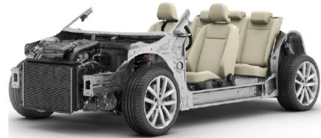
Abb. 9.18 MQB-Plattform von VW als Basis für die verschiedenen Fahrzeuge in Abbildung 9.17
