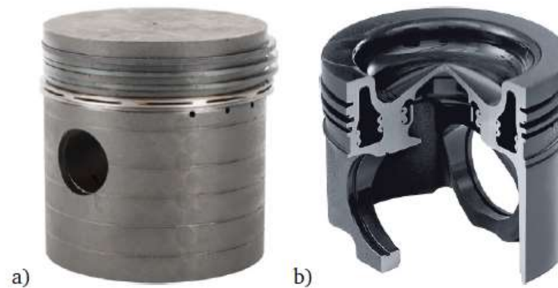
Abb. 5.20 Gestaltvariation am Beispiel eines Kolbens: a) ebener Kolbenboden, b) Kolben mit Freiformfläche zur Unterstützung der Gemischbildung
