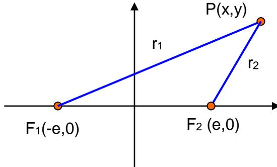
Zunächst wird angenommen, dass die beiden Fixpunkte  $F_1$  und  $F_2$  symmetrisch zur  $y$ -Achse liegen.
