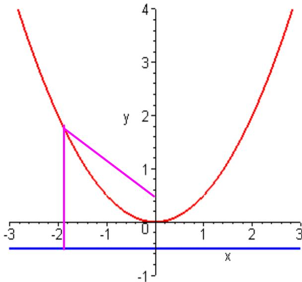
Der Fixpunkt  $F$  der Parabel heißt auch „Brennpunkt“. Parallel einfallende Lichtstrahlen oder andere elektromagnetische Wellen werden auf den Brennpunkt fokussiert. Eine im Brennpunkt angeordnete Lampe sendet paralleles Licht aus. Aus diesem Grund werden Antennen für elektromagnetische Strahlung mit einem sog. Parabolspiegel versehen, um Licht- und andere elektromagnetische Strahlung gerichtet auszusenden oder auf eine Stelle zu konzentrieren.
