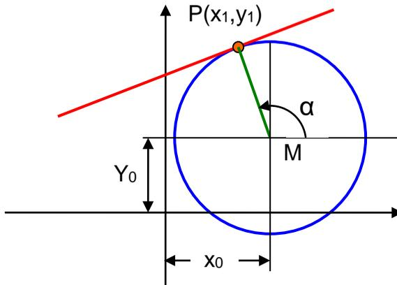
Zunächst wird die Steigung  $\alpha$  der Normalen berechnet.
