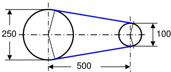
zwei Wellen im Abstand von 500 mm verbindet, wobei das größere Zahnrad einen Durchmesser von 250 mm und das kleinere den Durchmesser 100 mm hat?
