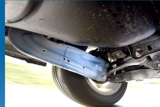
Abriss Längslenker: (Prinzipversuch)
