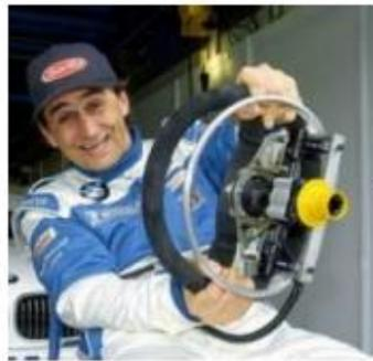
Fahrer führt Lenkbewegung aus und bringt somit ein Lenkdrehmoment auf einen Torsionsstab (Drehmomentsensor) auf
