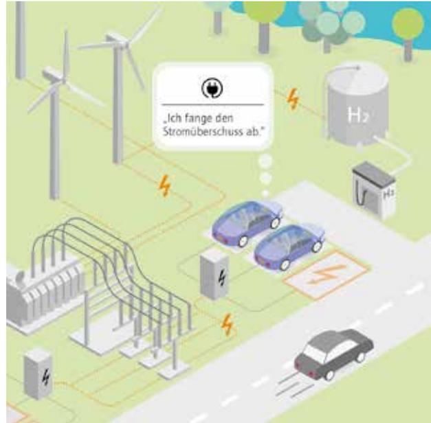
3.4.2 Sektorenkopplung von Energie und Verkehr – Fahrzeuge als mobiler Stromspeicher (Quelle: eigene Darstellung)
