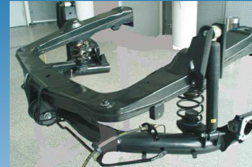
De-Dion-Achse mit Deichsel, Oberrahmen ist der Aggregateträger (HA: MB Smart, Bj. 1998)
